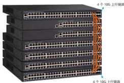
图 1: 最多可将 12 个 Ruckus ICX 7150 交换机堆叠在一起, 每个交换机最多可使用四个 SFP + 10 Gbps 端口, 以实现完全冗余背板, 提供 480 Gbps 的聚合堆叠带宽。
